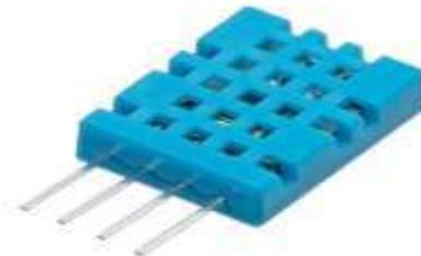
**Fig:** DHT Sensor
